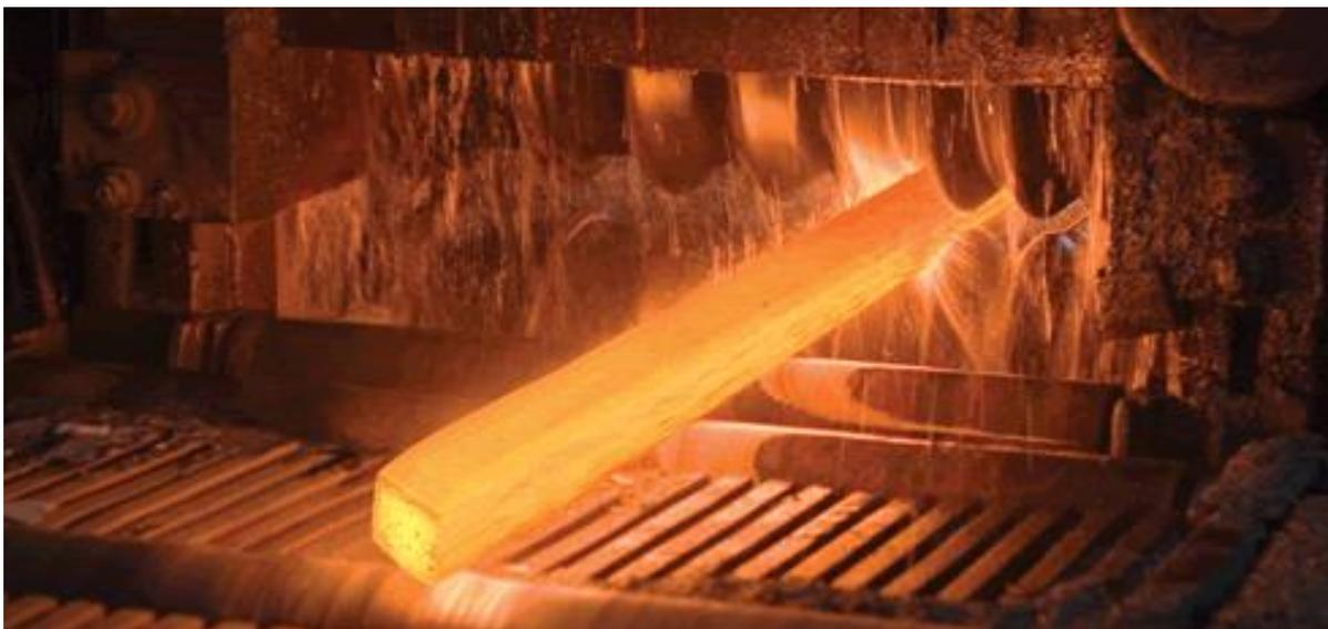
**Figura 7:** Laminação a quente de uma barra com perfil quadrado [18].
